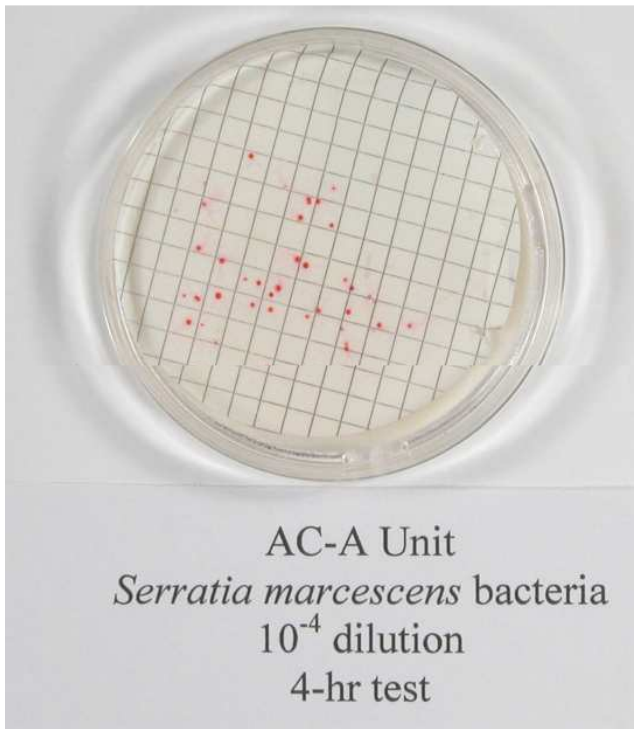
Purificatorul de Aer Control Figura 5. Coloniile Bacteriale Serratia Marcescens : Purificatorul de Aer A Test vs. Control
