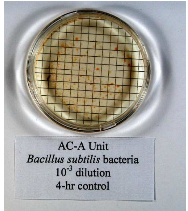
Purificatorul de Aer Control Figura 7. Coloniile Bacteriale Bacillus subtilis : Purificatorul de Aer A Test vs. Control
