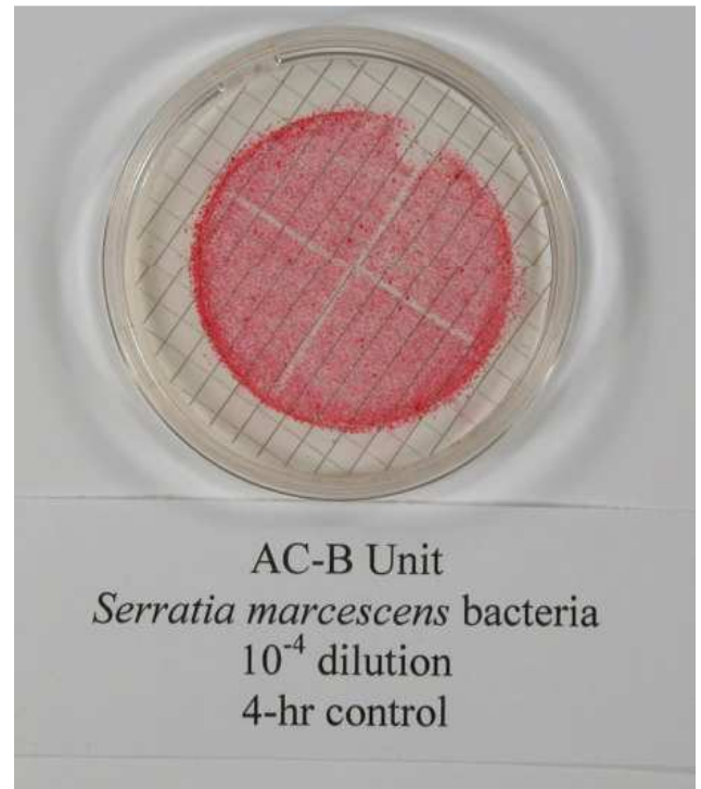
Purificatorul de Aer Control Figura 6. Coloniile Bacteriale Serratia Marcescens : Purificatoarele de Aer B Test vs. Control
