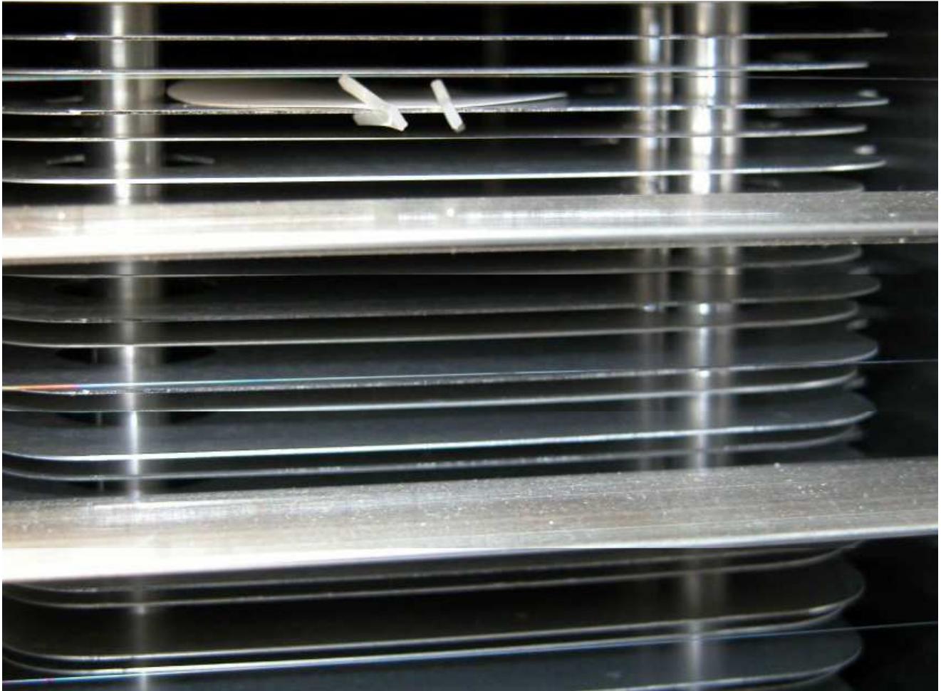
Figura 4. Plasarea Filtrelor care contin Microorganisme pe Paletele Purificatorului de Aer
