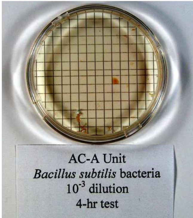
Purificatorul de Aer Control Figura 7. Coloniile Bacteriale Bacillus subtilis : Purificatorul de Aer A Test vs. Control
